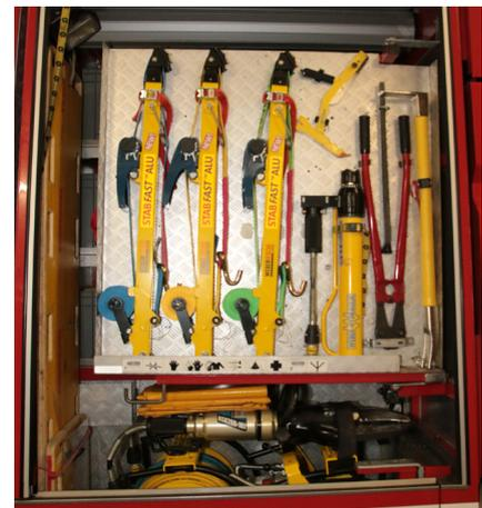
Bild: Neue Geräte im TLF (Stabfast Sicherungsstützen links; Halligantool ganz rechts)
